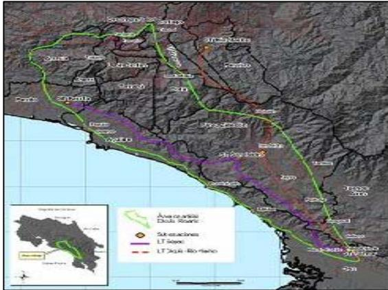
El tramo que aparece en color magenta constituye el segundo circuito de transmisión eléctrica de la línea de transmisión, conocida como SIEPAC (Sistema de Interconexión Eléctrica para América Central), donde el ICE tendría que colocar el segundo circuito. Actualmente, la línea se está construyendo y solo tiene un circuito; el otro lo tendría que construir el ICE como consecuencia del Proyecto Hidroeléctrico *El Diquís*.
