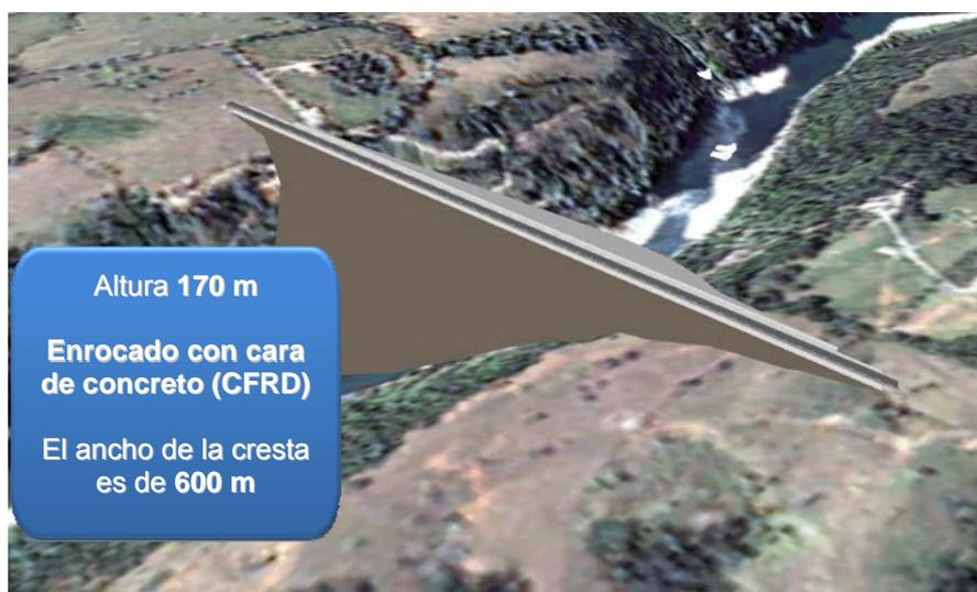
El ancho en la cresta o la superficie es de alrededor de 600 m de longitud; esto da pie a la conformación de un embalse de forma irregular "le hemos llamado especie de cruz o pata de gallo" de alrededor de 6.800 hectáreas, contemplando un nivel máximo de contención de las aguas en la costa 310, o sea los 310 m sobre el nivel del mar.
