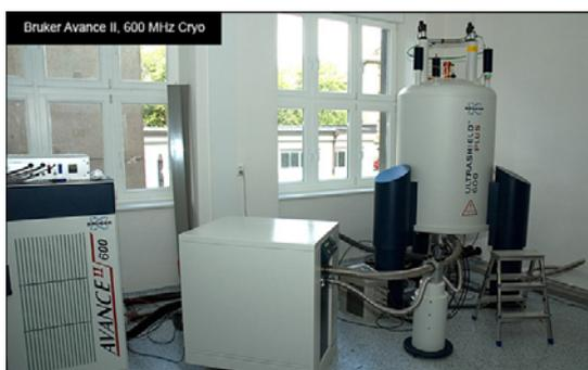
Figura: Espectrómetro de resonancia magnética nuclear.
